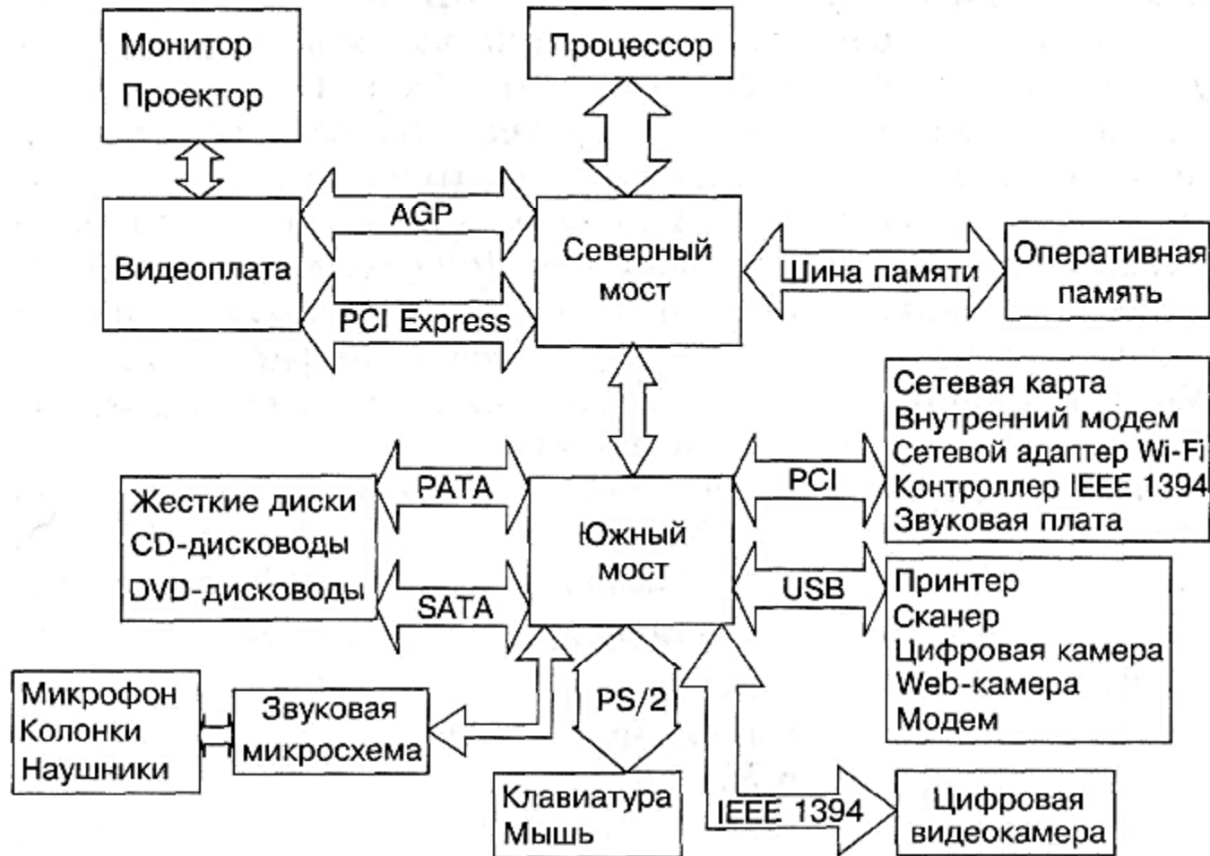
Логическая схема системной платы
