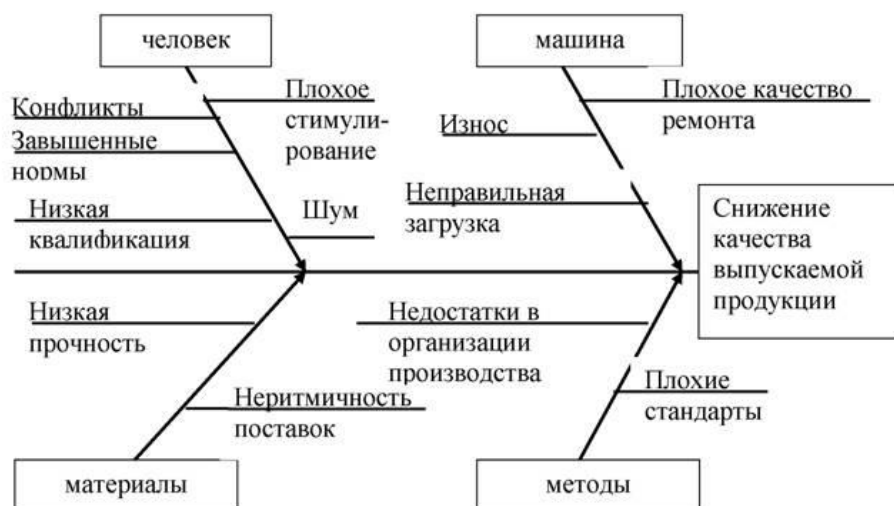
Рисунок 4- Возможные причины снижения качества выпускаемой продукции, согласно методу 4М
